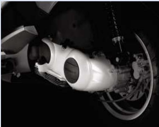
Le bloc moteur est monté sur double biellette et silent blocks pour renforcer la liaison châssis/moteur et vous offrir ainsi un comportement routier irréprochable. Quant aux suspensions (réglables en 4 positions), développées et testées pendant des milliers de kilomètres, elles proposent un tarage hydraulique spécifique garantissant un niveau de confort exceptionnel.
