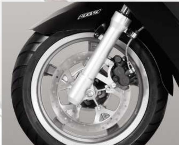
ABS/PBS\*: ce freinage 3 en 1 combine l'anti-blocage de la roue avant, le freinage couplé avant et arrière et une assistance au freinage qui optimise la puissance en amplifiant la pression exercée par le pilote sur le levier gauche.
