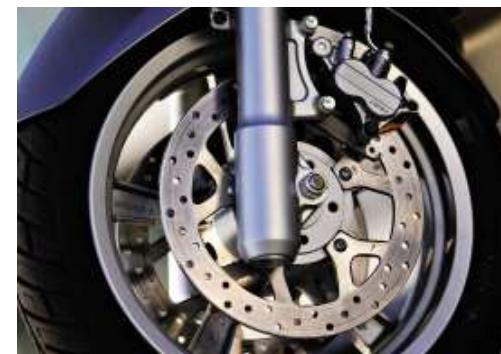
Un double disque Ø 260 mm à l'AV gage de sécurité et d'efficacité, en solo comme en duo, sur un véhicule pouvant atteindre des vitesses élevées.
