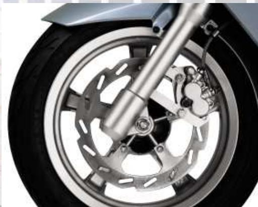
Disque AV de 260 mm avec étrier flottant double piston pour plus d'efficacité et de sécurité.
