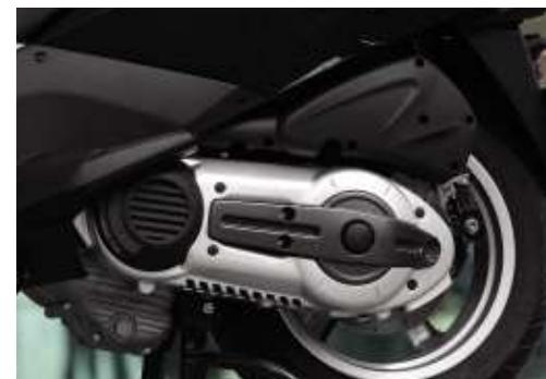
Une motorisation 400 cm<sup>3</sup> qui délivre sa puissance tout en progressivité idéale en conduite urbaine. Motorisation 398.9 (32.6 cv), refroidissement liquide, injection, 4 soupapes.
