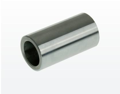
50cc Kymco Fahrzeuge, sowie einige SYM Scooter und GY6 50 4-Takter, werden von Werk aus mit einer speziellen Variomatikhülse gedrosselt. Durch die Verwendung der Racing Variomatikhülsen werden diese Drosseln aufgehoben. Die Verwendung ist Voraussetzung für weitere Tuningmassnahmen, um den Motor nicht mit einer gedrosselten Variomatik zu überlasten.
