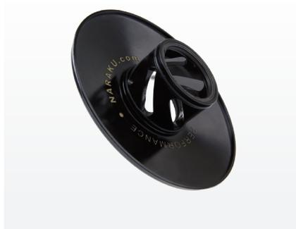
Sportwandlerscheibe mit linearem Führungsschlitz. Das Schaltverhalten des Wändlers kann über zwei unterschiedliche Führungsschlitze in der Scheibe ausgewählt werden. Die linearen Führungsschlitze übertragen die Kraft direkter. Besonders sinnvoll bei getunten Motoren mit engerem Drehzahlband.
