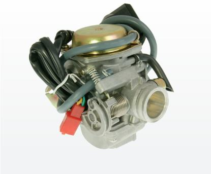
Tuningvergaser CVK mit 24mm Durchlass. Dieser Vergaser ist optimal ausgerüstet, um das volle Potential aus den 52,4mm / 90cc Big Bore Zylindern zu holen. Luftfilteranschluss 42mm. Lieferung inkl. E-Choke und montierter 102er HD. Ohne Beschleunigerpumpe; dadurch kein Überfetten. Kann bei 125cc Fahrzeugen auch als Ersatzteil verwendet werden. Zur optimalen Verwendung auf Big Bore Zylindern in Verbindung mit 24mm Ansaugstutzen und Ansaugspacer NK200.04. Hauptdüse M5. Luftfilteranschluss 38mm.
