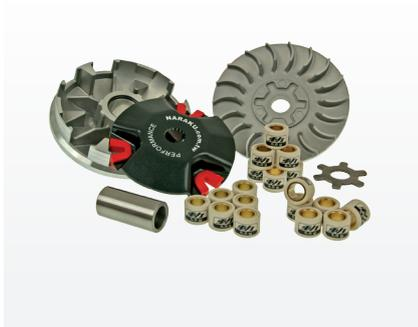
Die HS-Racing Variatoren sind erstklassig verarbeitet und werden mit CNC bearbeiteten Keilriemenscheiben ausgeliefert. Die Rollenlaufbahnen sind durch Glasperlenbestrahlung oberflächengehärtet, sehr verschleissarm und erreichen eine maximale Übersetzungsänderung mit sehr guten Durchzugswerten. Im Kit enthalten sind 3 Satz Variorollen 15x12mm mit 5,0 g / 5,5 g / 6,0 g.
