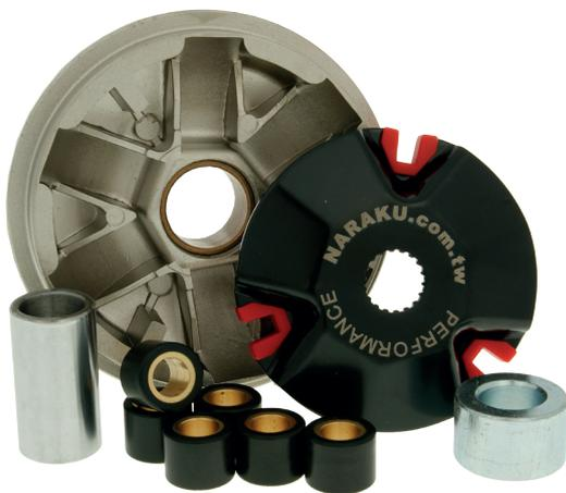
Preiswerte Sportvariomatik mit Ausrichtung auf Drehmoment und bessere Beschleunigungswerte. Die Endgeschwindigkeit steigt bei diesem Variator nicht ganz so stark. Wird mit einem Satz Variorollen geliefert.
