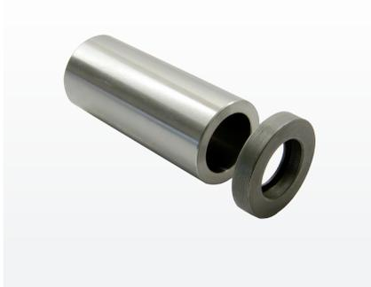
Die Racing Variomatikhülse verhilft der Variomatik den Keilriemen bei Höchstgeschwindigkeit weiter nach aussen zu treiben. Damit gelangt die Variomatik in ein anderes Übersetzungsverhältnis und kann je nach Motorleistung 15 Km/h und mehr Top Speed erreichen. Die Hülse kann im Originalvariator verwendet werden oder auch im Austausch gegen die Hülse in Tuningvariatoren. Besonders sinnvoll in Tuningvariatoren, da diese zusätzlich noch die Beschleunigung verbessern.
