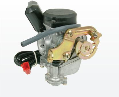
Nach japanischen Standards gefertigter CVK-Vergaser in taiwanesischer Erstausrüsterqualität. Engere Fertigungstoleranzen verhindern Leistungslöcher, ermöglichen feineres Ansprechverhalten und beseitigen unrunder Motorlauf sowie vergaserbedingte Startprobleme. Wird inklusive E-Choke und 85er HD geliefert. Einsetzbar von 50cc bis 90cc Hubraum. Entspricht im Aufbau dem Originalvergaser. Hauptdüse M4, Luftfilteranschluss 38mm.
