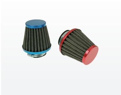
Preiswerter Tuningluftfilter mit eloxierten Endkappen. Die Filter sind mit einem Stahlgeflecht und Filzeinlage ausgestattet. Durch den erhöhten Luftdurchsatz muss unter Umständen die Vergaserbedüsung angepasst werden.
