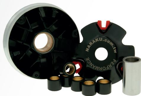
Sportvariomatik mit Ausrichtung auf Drehmoment und bessere Beschleunigungswerte. Die Endgeschwindigkeit steigt bei diesem Variator nicht ganz so stark. Wird mit einem Satz 16 x 13 mm Variorollen in 6,0 g geliefert.
