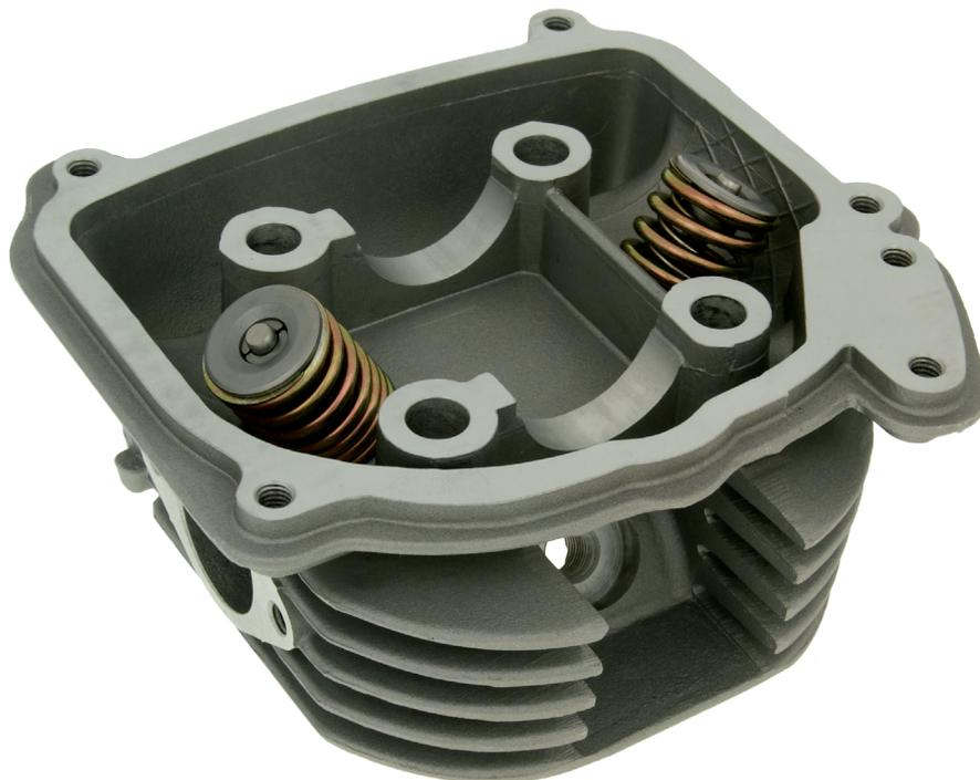
Ersatzzylinderkopf für 125cc in Originalteilqualität taiwanesischer Fahrzeughersteller. Hochlegierte Ventileführungen und spezielle Ventile sorgen für verschleissarmen Einsatz. Besonders die Ventileführungen sind Fehlerquelle Nr. 1 bei chinesischen Originalteilen. Der Kopf wird montagefertig, inkl. montierten Ventilen und Federn geliefert. Übertrifft deutlich die Qualität chinesischer Erstausrüster.
