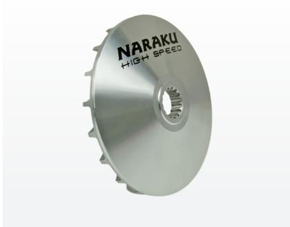
Die CPI-Version ist „durchverzahnt“ und verzichtet durch die spezielle Bauform auf die anfällige Sternscheibe. Beim Original bricht allzu häufig die Sternscheibe und führt, durch eine lose, sich mitdrehende Riemenscheibe, zu fatalen Schäden an der Kurbelwelle und dem Riementrieb. Die Vorteile einer CNC gefertigten Riemenscheibe sind natürlich auch hier vorhanden.
