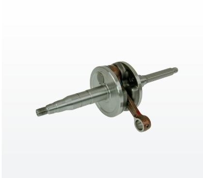
Kurbelwelle mit 10 mm Kolbenbolzen und
