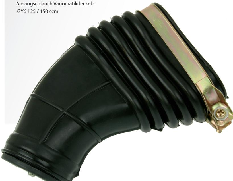
Der Ansaugschlauch für den Variomatikdeckel bildet eine Belüftungs- und Schutzfunktion. Die angesaugte Luft wird aus dem geschützten Fahrzeugbereich direkt in den Variomatikdeckel transportiert und kühlt den kompletten Antriebsstrang. Das ist wichtig um Verschleiß zu vermeiden. Zusätzlich verhindert der Schlauch das Eindringen von Fremdkörpern und Staub.
