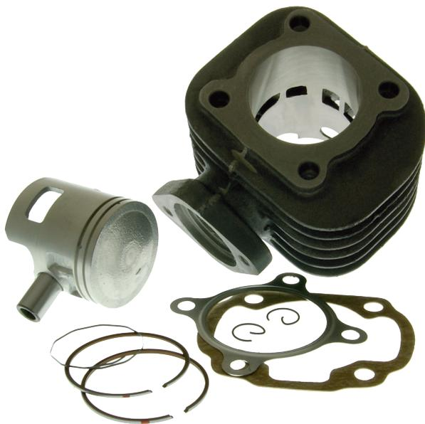
70cc Graugusszylinder für das preiswerte Sporttuning. Es muss nicht immer der Racingzylinder sein. Die Zylinder sind sehr drehmomentorientiert und mit geringer Drehzahlsteigerung. Mehr Kraft aus dem niedrigen Drehzahlbereich zeichnet diesen Zylinder aus. Tauglich für Originalauspuffanlage.
