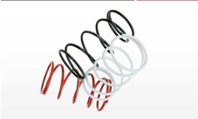
NARAKU Gegendruckfedern verwenden zur Klassifizierung den Anstieg der Verschalt Drehzahl. Bei gleichbleibenden Variorollen und Montage der 1000er GDF verschaltet die Varioomatik nun ca. 1000 U/min später. Das erleichtert die Auswahl der richtigen Feder. Sie sind einzeln oder in Sätzen erhältlich.
