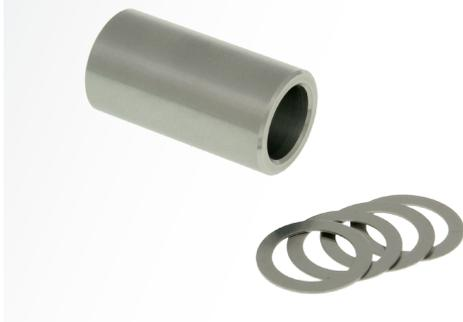
Der Speed-up-Kit besteht aus einer verkürzten Variomatikhülse und einigen Controlscheiben. Mit diesen Scheiben lässt sich die Länge der Variomatikhülse ändern. Dadurch wird das Übersetzungsverhältnis der Vario verändert. Kürzere Hülse mehr Endgeschwindigkeit und etwas weniger Beschleunigung. Längere Hülse mehr Beschleunigung und etwas weniger Endgeschwindigkeit. Stellt man die Länge der Originalhülse ein, ändert sich nichts.
