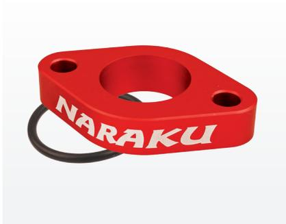
CNC-gefräster Aluminiumansaugspeicher, zur Reduktion des Ansaugquerschnitts auf den Einlasskanal des Big Bore Zylinderkopfes 52,40mm / 90cc von 22mm Ansaugstutzen. Der eintretende Venturi-Effekt beschleunigt zusätzlich die Gassäule. Nach Anpassungsarbeiten am Zylinderkopf, ist dieser auch auf Originalköpfen verwendbar.
