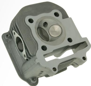
Tuningzylinderkopf mit größeren Ein- und Auslassventilen und vergrößertem Brennraum. Einsetzbar ab 160cc Hubraum. Empfohlen in Verbindung mit 170/180cc Zylinderkits. Bei der Verwendung auf 125cc Kymco AC Motoren muss die Steuerkette GY15013 verwendet werden, um die flachere Bauweise des Tuningzylinderkopfes auszugleichen.
