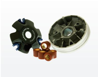
Günstiger Ersatzvariator ohne Leistungssteigerung. Der Kit wird ausgeliefert mit einem Satz Variogewichte 16x13mm, in 5,5g. Kann mit gedrosselten oder ungedrosselten original Variomatikhülsen verwendet werden.
