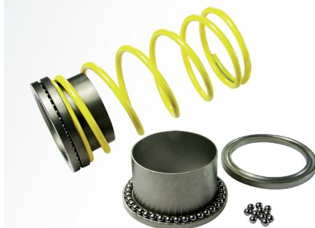
Der starre Teller der Gegendruckfeder wird durch die kugelgelagerte Twist Control ausgetauscht und verhindert die bei der Wandlertätigkeit auftretenden Torsionskräfte der Feder. Der Wandler schaltet wesentlich leichter und weicher. Einsatzbereich von standard bis Racing Motoren. Spürbarer Effekt bereits ab 50cc. Lieferung ohne Gegendruckfeder.
