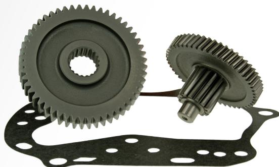
Verlängertes Getriebe zur Geschwindigkeitssteigerung von GY6 50 4-Takt Fahrzeugen. Voraussetzung ist ausreichend Motorleistung durch Big Bore-Zylinderkits. Das Getriebe erreicht eine Verlängerung von ca. 10% und ist optimal auf die 50er 4-Takter abgestimmt. Das Sekundärgetriebe ist, montagefreundlich, bereits fertig verpresst. Kein Spezialwerkzeug notwendig. Der Satz wird mit neuer Getriebedeckeldichtung geliefert.
